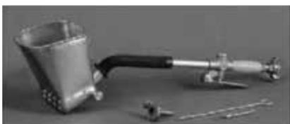
El uso de estos equipos permite disminuir el tiempo de ejecución en un 50% con respecto al sistema tradicional, sin necesidad de contar con personal especializado. Las revocadoras M2 permiten la aplicación del mortero con una adherencia que no sería posible de alcanzar en forma manual. Un operario que utiliza una revocadora M2 y cuenta con el aporte continuo de material puede llegar a revocar 1 cm de espesor sobre una superficie de 60 m<sup>2</sup> en una hora de trabajo.
